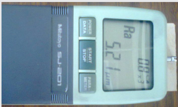
Figura 6. Fotografía de la rugosidad inicial de probeta.
