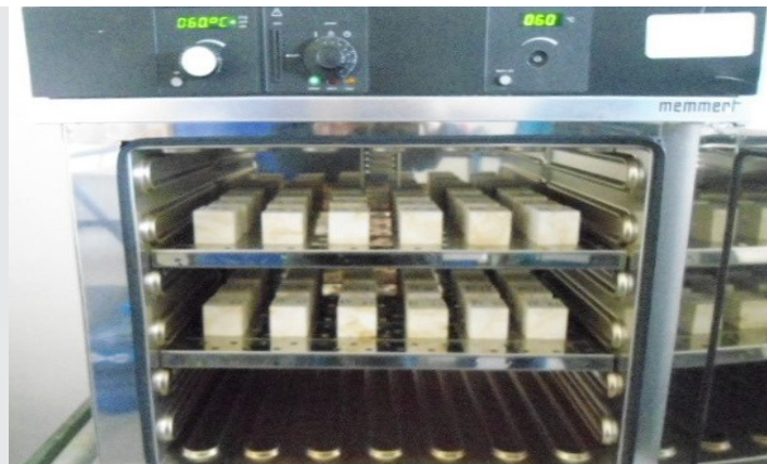
Figura 5. Fotografía del secado de las 48 probetas.
