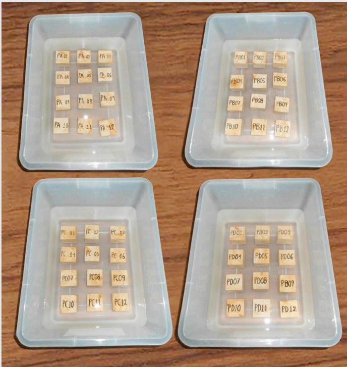
Figura 7. Fotografías de la inmersión de las 48 probetas.
