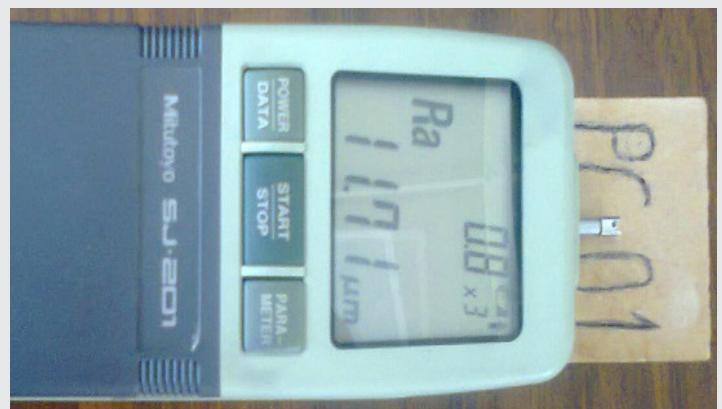
Figura 9. Fotografía de la rugosidad final de probeta.
